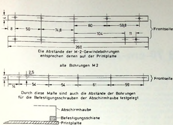
Bild 16. Befestigungsschienen für die Abschirmhaube der Baugruppe HS (Material: Ms-Profil, 4 mm x 4 mm)
