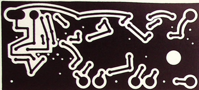
Bild 4. Printplatte des Transistor-Einkreisers (Maßstab 1:1)
